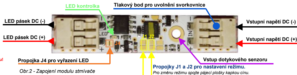
Obr. 2 - Zapojení modulu stmívače
