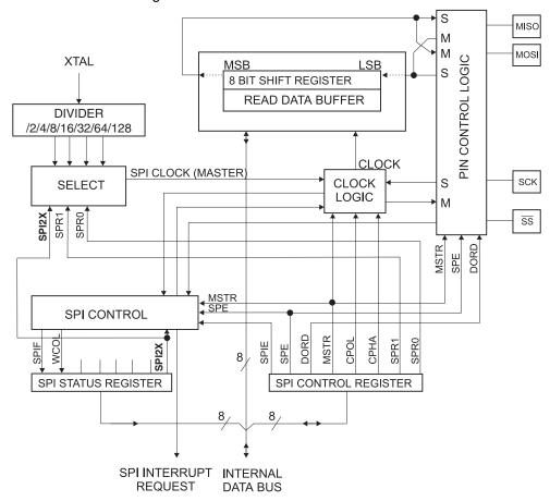
Figure 18-1. SPI Block Diagram<sup>(1)</sup>
