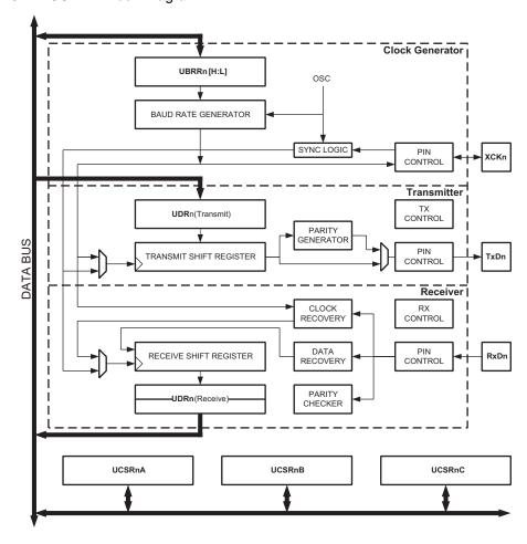
Figure 19-1. USART Block Diagram<sup>(1)</sup>
