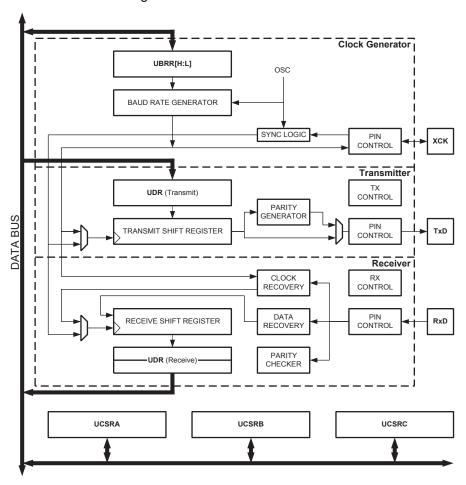
Figure 20-1. USART Block Diagram<sup>(1)</sup>
