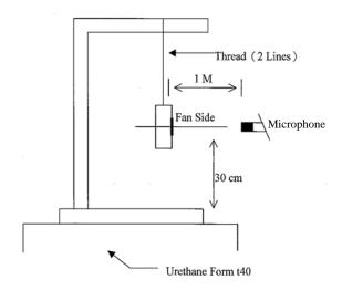
1 METER FROM MICROPHONE TO FAN INTAKE
