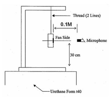
0.1 METER FROM MICROPHONE TO FAN INTAKE
